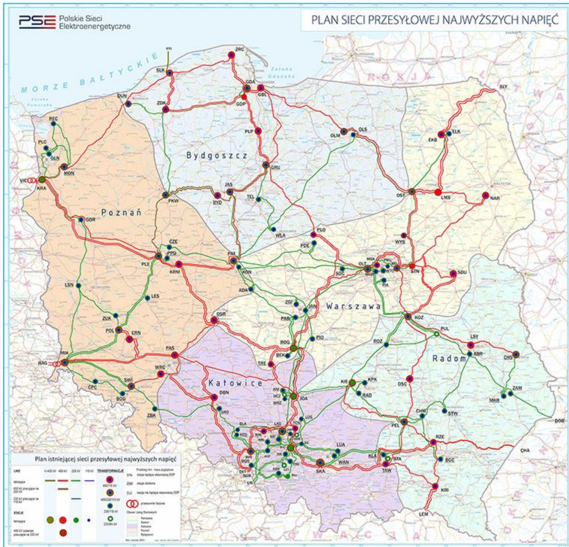
Rysunek 13 Schemat Krajowej Sieci Przesyłowej Źródło: PSE, www.pse.pl , data dostępu: 22.03.2024
